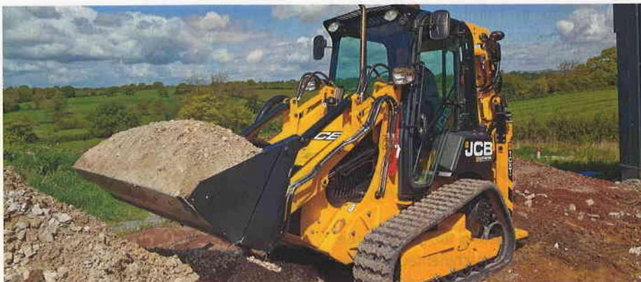
*Mit seiner Kompaktheit und der Fähigkeit, sich 360° um die eigene Achse zu drehen, bringt der komplett überarbeitete kleinste JCB-Baggerlader 1CXT die Leistung und Funktionen eines Baggerladers auch an bisher unzugängliche Einsatzorte. (Foto: JCB)*
