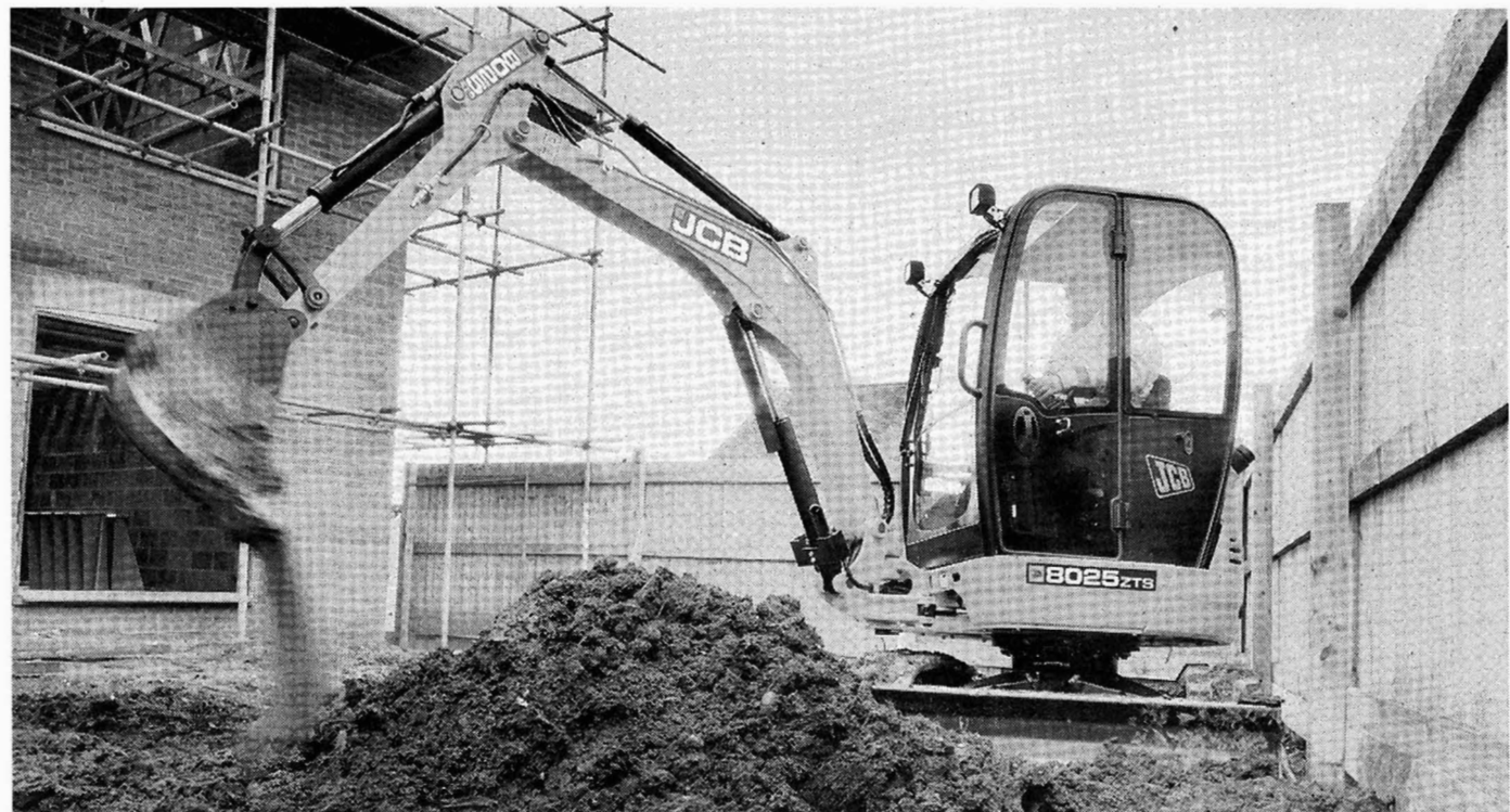
In der 2,5- bis 3,5-t-Klasse bieten die Kompaktbagger 8025 (Foto), 8030, 8035 ZTS einen Nullhecküberstand und tragen dem Bedarf nach immer kompakteren Maschinen Rechnung.
