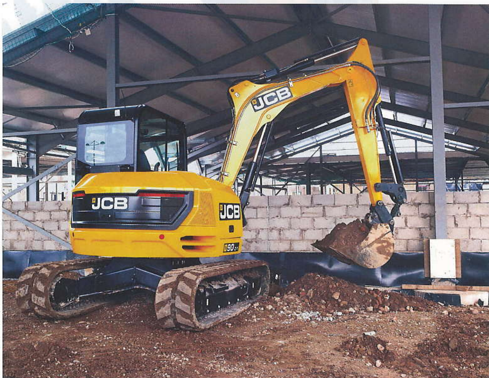
Das Design und die massive Konstruktion des schwenkbaren Auslegers machen den 90Z im Vergleich mit einem konventionellen Dreizehntonnen-Raupenbagger und normalem Ausleger insbesondere für beengte Baustellen interessant. | Foto: JCB
